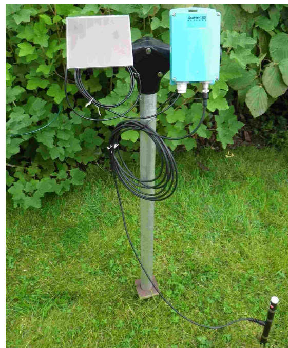
Scatter-SDI12-Modul mit Mini-Solarpanel und Bodentemperatur-Profilsonde
